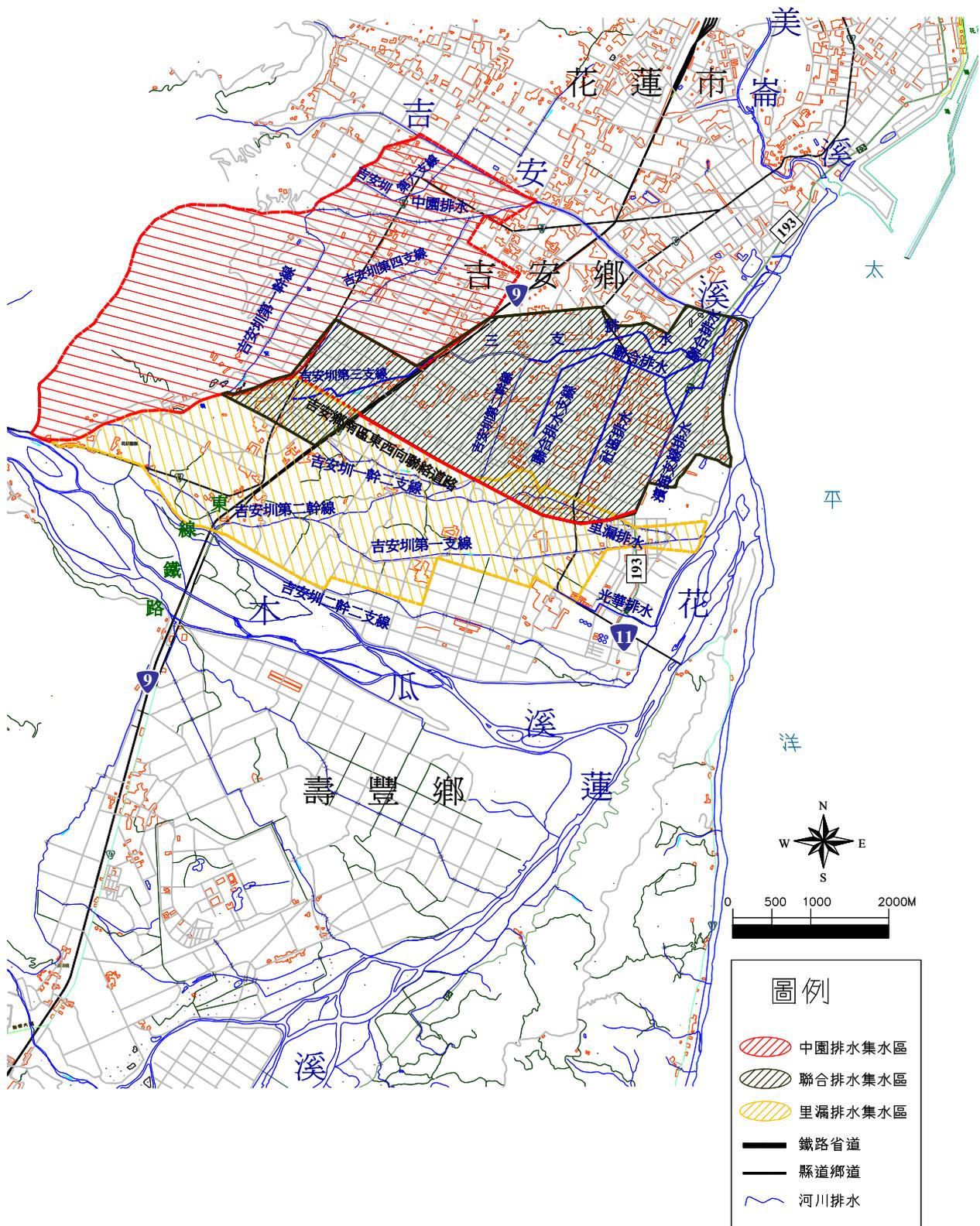
圖 2-1 聯合排水系統以及鄰近排水系統集水面積圖
